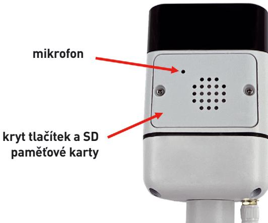
Do kamery můžete zasunout SD kartu o kapacitě až 64GB. Při zasouvání kartu orientujte kontakty SD karty směrem k desce elektroniky.
