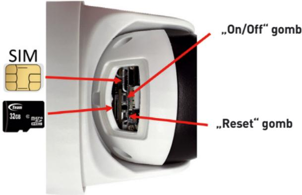
A kamerába legfeljebb 64 GB kapacitású SD-kártyát helyezhet be. Behelyezéskor fordítsa a SD kártyát az érintkezőivel az elektronikai lap felé. SD kártya nem szükséges a kamera működéséhez.
