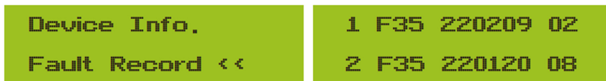
Obr. 8.13 Záznam o poruše
