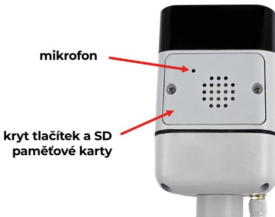
Do kamery můžete zasunout SD kartu o kapacitě až 64GB. Při zasouvání kartu orientujte kontakty SD karty směrem k desce elektroniky.
